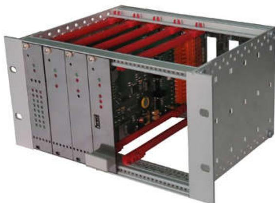
Стойка контроля механических величин и температуры разработана для мониторинга состояния роторного оборудования на промышленных предприятиях и позволяет выполнять:
