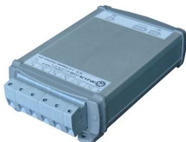
Преобразователь измерительный ПР-01-ТК предназначен для непрерывного измерения параметров трехфазной сети без нейтрали, передачи результатов измерений по интерфейсу RS-485 (протокол Modbus RTU) и преобразования в два унифицированных сигнала постоянного тока следующих величин: токи и линейные напряжения по двум фазам, активная мощность, реактивная мощность, полная мощность сети, коэффициент мощности.
