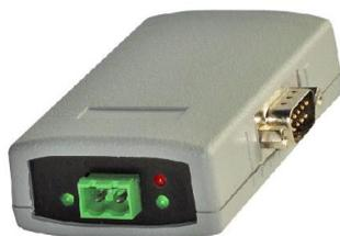
Адаптер интерфейсный RS-1-TK-USB предназначен для согласования интерфейсных сигналов RS-485 и USB при организации обмена данными по одному каналу последовательной связи между приборами, оснащенными интерфейсом RS-485, и ПК.
