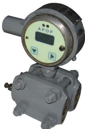
Автономный регистратор объемного расхода АРОР предназначен для непрерывного измерения расхода жидкости, вычисления суммарного объема, накопления в энергонезависимой памяти информации об измеренном объеме в течение часа, суток, месяца.
