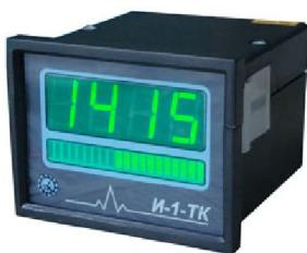
Индикатор технологический И-1-ТК-14 предназначен для измерения унифицированного сигнала постоянного тока, преобразования измеренного значения в пропорциональное значение физической величины, отображения результатов измерения на цифровом индикаторе, а также на индикаторе уровня.
