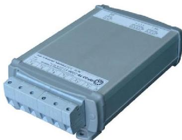
Преобразователь измерительный ПР-03-ТК предназначен для непрерывного измерения параметров трехфазной сети с нейтралью, передачи результатов измерений по интерфейсу RS-485 (протокол Modbus RTU) и преобразования в два унифицированных сигнала постоянного тока следующих величин: фазные напряжения и токи по трем фазам, активная мощность, реактивная мощность, полная мощность сети, коэффициент мощности.
